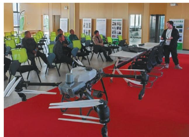
名气的林业大载重吊运无人机“浙林勇士”。这款电动多旋翼无人机凭借强大的载重能力一举成名,无论是喷洒农药、播撒种子还是施肥、肥料吊运还是毛竹吊运都应对自如,加上先进的飞行控制和智能作业系统用于识别农田边界、自适应地形、分类作物,使其得以在精准定位的同时自主作业。此外,“浙林卫士”“森巡者”系列无人机根据病虫害监测防治、应急救援、森林防火等场景定制,针对性强、匹配度高,能从根本上解决传统人工难以达到、无法作业等问题。
