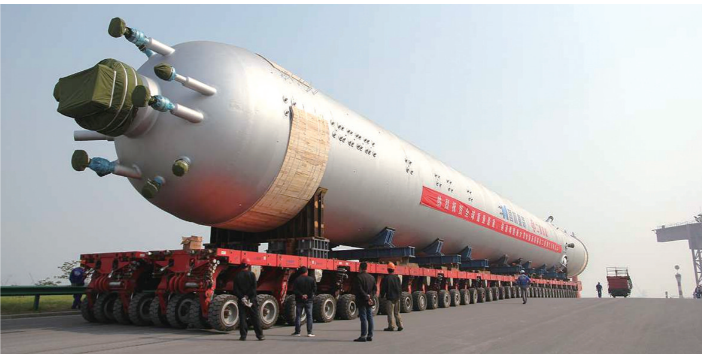
国机重装所属二重装备制造的世界最重(2400吨)沸腾床渣油加氢反应器在国机重装镇江基地发运
