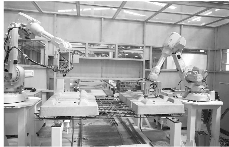
智能化生产线上正在生产轨枕(成达万高铁公司供图)
