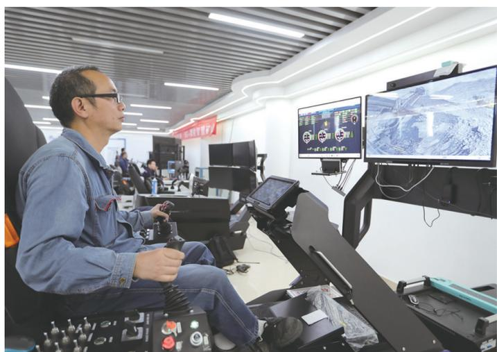
4月11日,技术人员在攀钢矿业朱兰铁矿智慧管控中心进行电铲远程操控。
