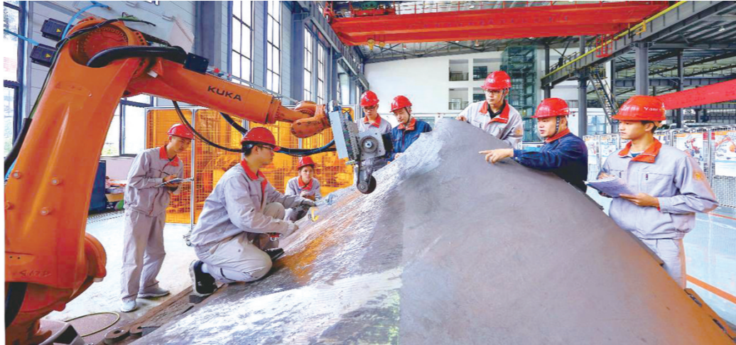
实训老师指导学生参与大型铸件毛坯智能化打磨装备研发实训现场（四川工程职业技术大学供图）
