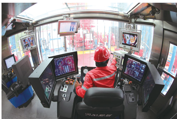
12000米特深井自动化钻机的工作室（刘梅 摄）
