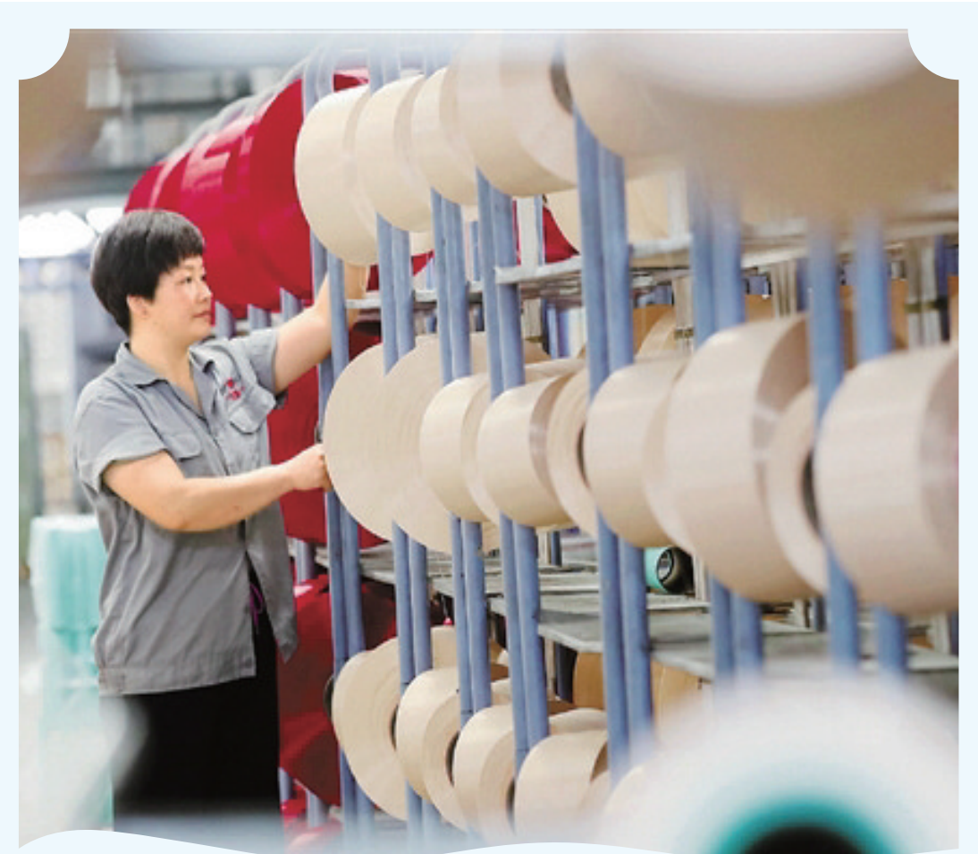
位于湖州市德清县的汇隆新材料股份有限公司纺丝加弹生产车间内,工人正在赶制差别化有色涤纶长丝产品。这家高新技术企业通过采用原液着色纤维工艺,从源头上解决了传统印染行业存在的高能耗、高水耗等突出问题,其产品在国内外市场备受青睐。
