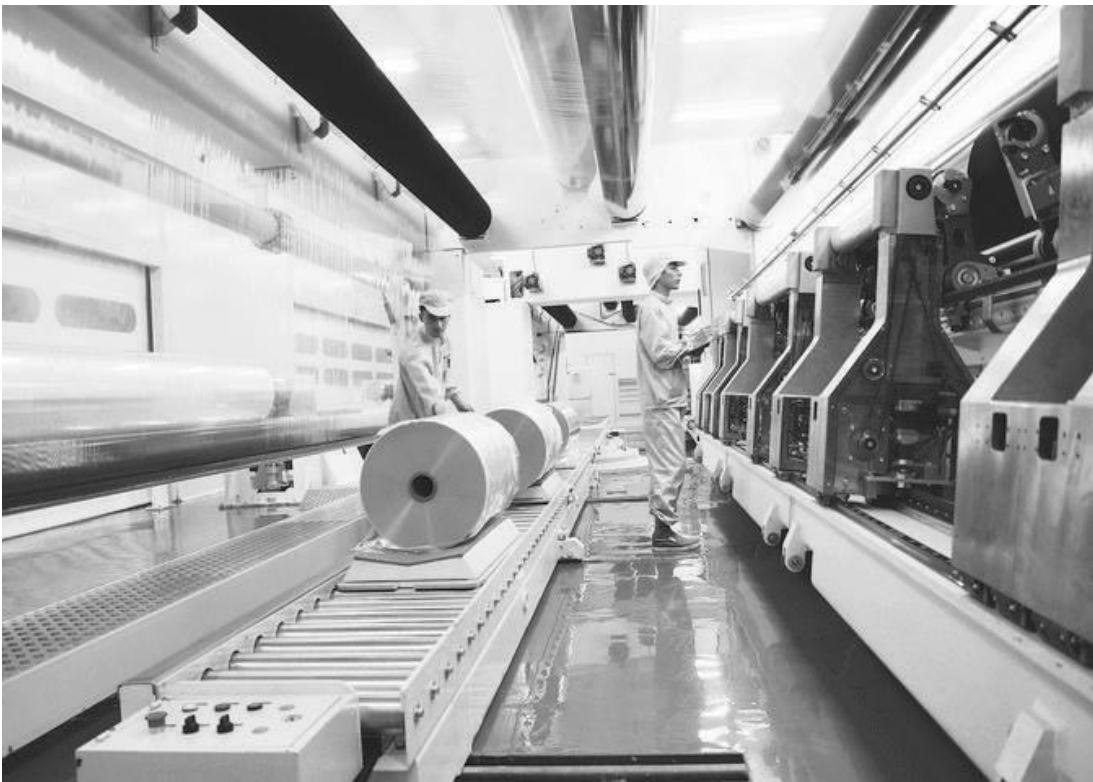
安徽国风新材料股份有限公司电容膜车间内,工人正在进行卸膜作业。
