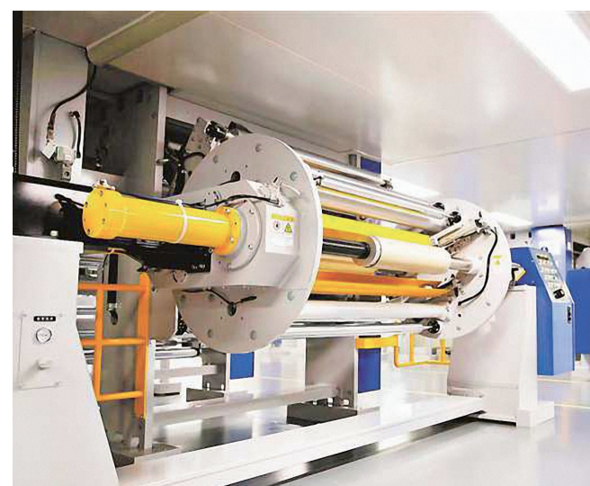
图为江苏厚生重庆基地无尘生产车间里,智能化生产线在生产锂电池隔膜。
