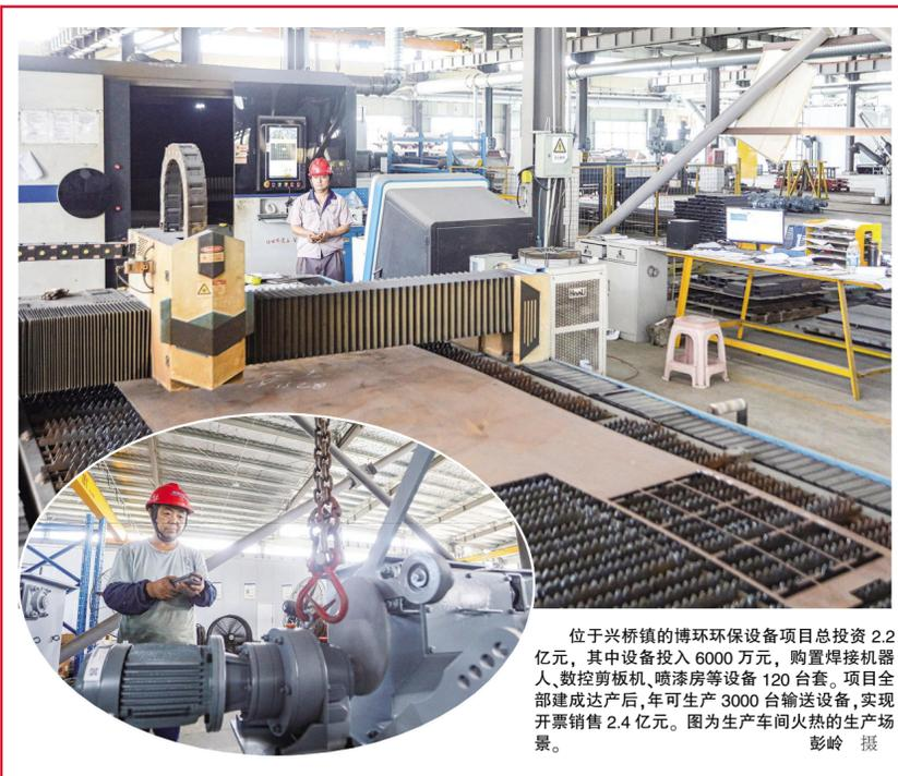
位于兴桥镇的博环环保设备项目总投资2.2亿元,其中设备投入6000万元,购置焊接机器人、数控剪板机、喷漆房等设备120台套,项目全部建成达产后,年可生产3000台输送设备,实现开票销售2.4亿元。图为生产车间火热的生产场景。彭岭 摄
