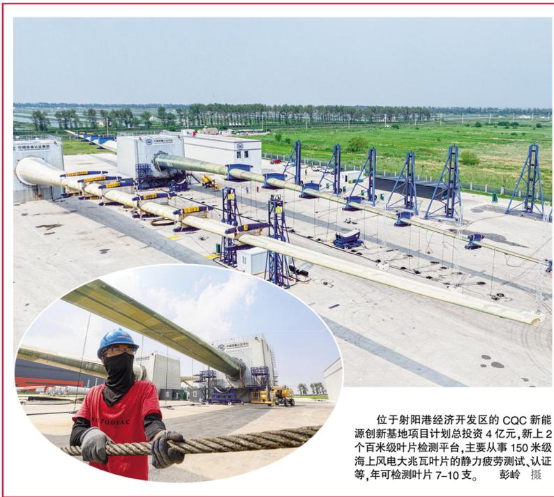
位于射阳经济开发区的CQC新能源创新基地项目计划总投资4亿元,新上2个百米级叶片检测平台,主要从事150米级海上风电大兆瓦叶片的静力疲劳测试、认证等,年可检测叶片7-10支。彭岭 摄
