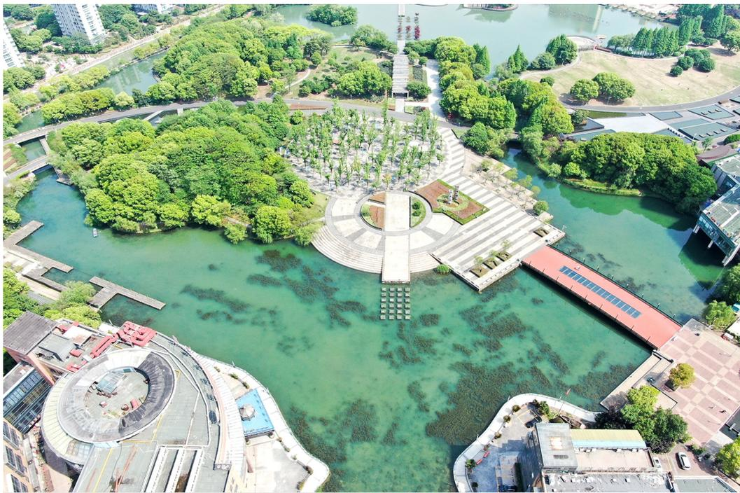
新天地公园湿地项目计划建设湿地面积6.2万平方米，将通过柔性围隔、底质改良和水质调节，创造沉水植物生长的基底条件，构建以沉水植物群落为主的生态湿地。建成后，原有水面变为城区河道的旁路湿地，进一步改善周边河道水环境。2023年11月，该项目已先期实施完成公园北部样板段工程，共布置沉水植物16818平方米，植物品种包括四季常绿矮化苦草、轮叶黑藻、金鱼藻、睡莲等。图为项目航拍。 陆新钱 摄
