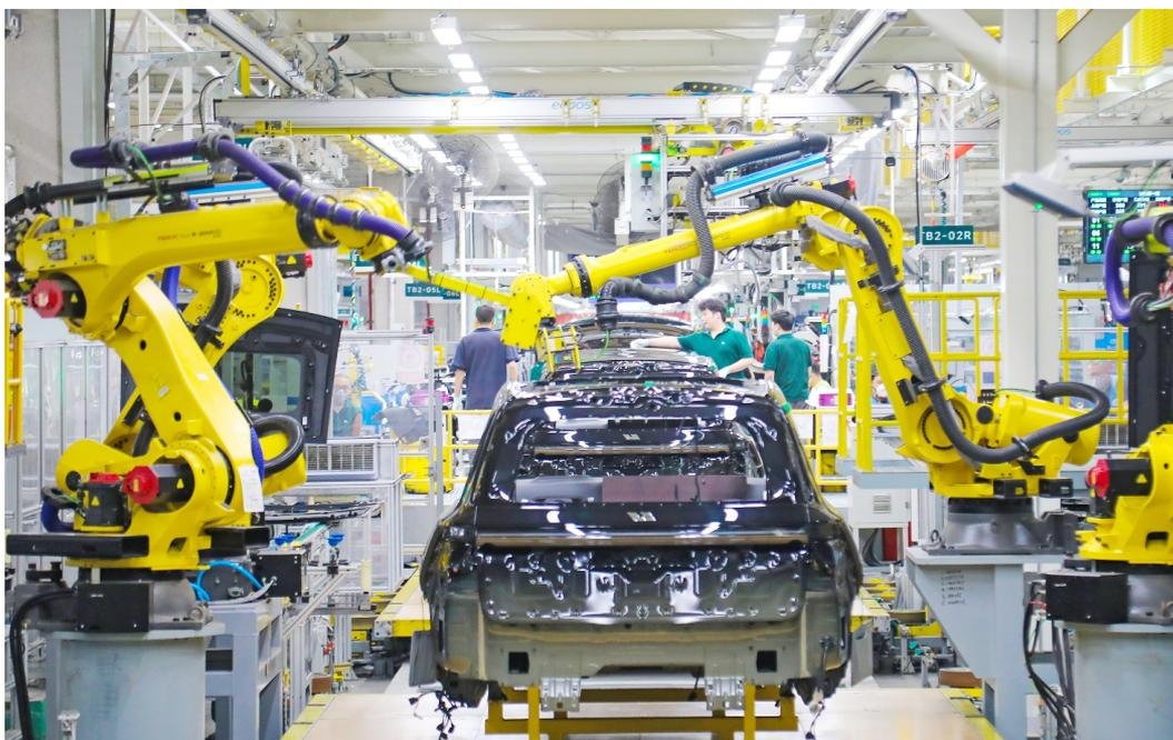
位于武进国家高新区的理想汽车常州智能制造基地，涵盖冲压、焊装、涂装、总装、检测、物流等完整的整车生产流程。近年来，该基地不断完善智能化生产体系，其中理想L6产线的综合自动化率已经超过80%，实现了更高的生产效率与交付质量。理想L6的6月产能将突破2万台。图为该基地智能化生产车间。陆新 徐芊卉摄
