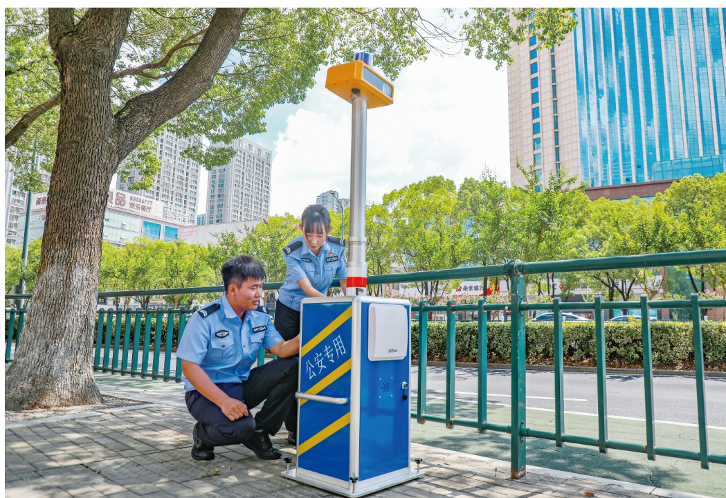
为织密道路交通管控网络,督促非机动车驾驶人安全文明出行,近日,武进交警在部分重点路段启用可移动的多功能劝导机器人,可自动识别驾乘电动自行车不戴头盔、骑车使用手机、逆行等交通违法行为,实时语音播报,开展交通安全宣传提醒,引导市民遵守交通规则。图为交警正在调试非机动车移动布控设备。 陆新 徐晶玮摄
