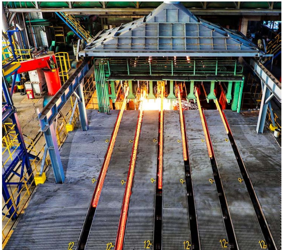
位于湟里镇的东方润安集团有限公司是一家集钢铁、导轨、铜业研制于一体的现代化制造企业，位列2024中国制造业民营企业500强第93位。近年来，该企业力推“智能化改造、数字化转型”，目前炼钢厂的自动化率达100%，数字化和智能化率达90%以上，每日炼钢产量近1万吨。图为炼钢厂自动化生产线。
