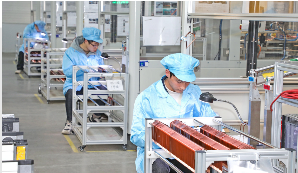
位于湖塘科技产业园的叁零陆(江苏)动力部件有限公司是一家以生产新能源汽车核心零部件、新能源汽车扁线电机为主的企业。企业自主研发的全自动生产线可全面检出焊点内外侧、左右侧及顶部各方位所有缺陷，检测精度范围约0.1毫米，属国内领先工艺水平。目前，该企业已成为国内多家知名新能源汽车企业的重要供应商。 钱垒 摄
