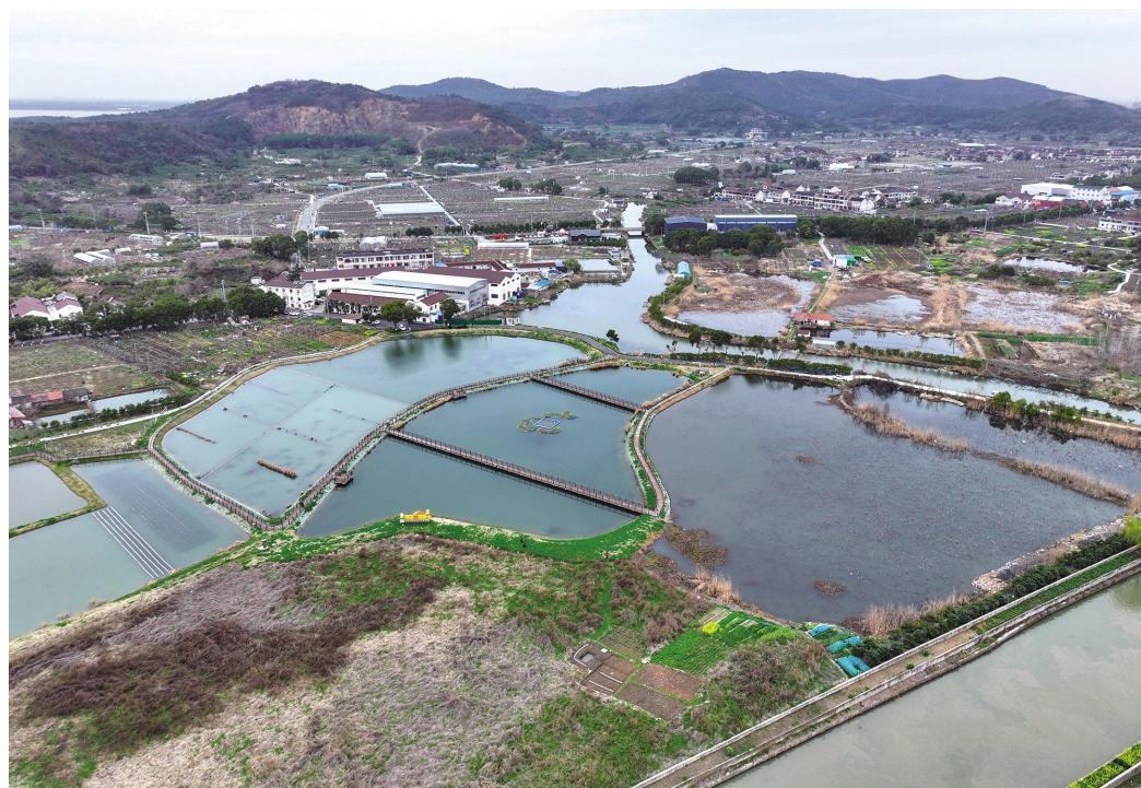
近日,在位于雪堰镇的雅浦港生态缓冲区,雅浦村桃树种植尾水净化示范工程已为新一年的桃树栽培做好准备。据悉,周边种植的橘园、桃林会产生大量农业污水,极大增加太湖蓝藻暴发率。该工程通过对相关区域内的农村生活污水接管,将各类尾水引流到雅浦港生态缓冲区,经处理达到Ⅲ类水标准后,再流入太湖,为太湖水治理竖起一道屏障。目前已经实现对山上70多万平方米橘园、桃林等的覆盖。 徐芊卉摄
