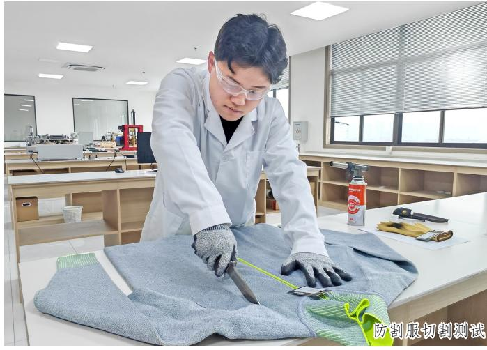
在江苏科旭纺织科技有限公司实验室内,一道寒光划过灰绿色面料,伴随金属摩擦的锐响,工作人员手持利刃对防割服进行上百次切割测试——刀刃过处仅仅留下几道浅痕。据悉,这件神奇的防割服,曾获工信部2023、2024年度中国十大类纺织创新产品称号,正诠释着传统纺织业的硬核蜕变。
