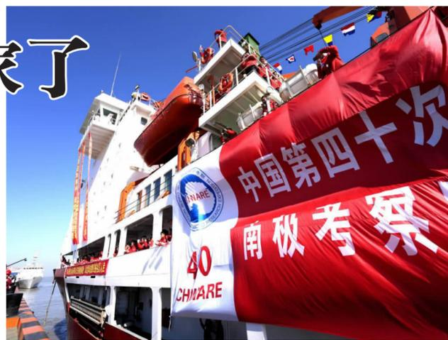
年10月,中国自主建造的第一艘极地科学考察破冰船“雪龙2”号首航南极,开启了“双龙探极”的新时代。“雪龙2”是国际上第一艘采用船艏、船艉双向破冰技术的极地科考破冰船。该船全长122.5米,可以破除1.5米厚的冰层。
