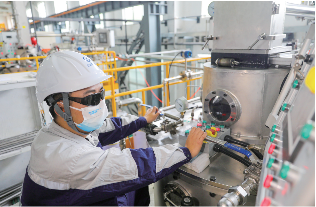
江苏威拉里新材料科技公司大力推进创新驱动战略,聚力攻关核心技术,打造行业隐形冠军。图为该公司职工操作自主研发、国际领先的EIGA设备进行钛合金粉末雾化生产。
