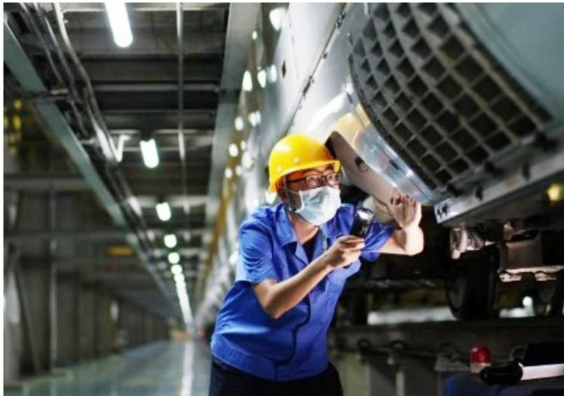
8月9日,在中国铁路上海局集团有限公司南京动车段动车车载设备车间,工作人员正在检修动车速度传感器。
