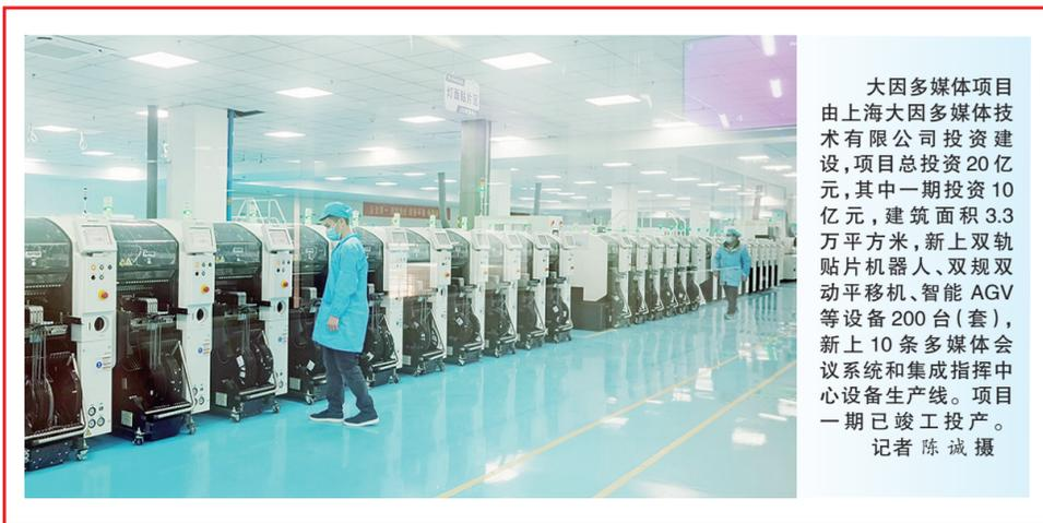
大因多媒体项目由上海大因多媒体技术有限公司投资建设,项目总投资20亿元,其中一期投资10亿元,建筑面积3.3万平方米,新上双轨贴片机器人、双规双动平移机、智能AGV等设备200台(套),新上10条多媒体会议系统和集成指挥中心设备生产线。项目一期已竣工投产。记者 陈诚摄
